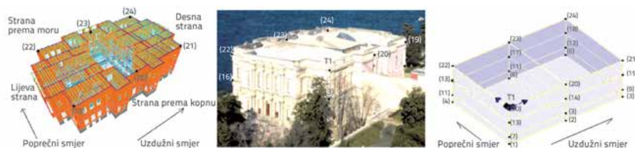
Slika 9. Numerički model i eksperimentalno određena geometrija građevine
