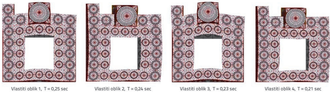
Slika 5. Prva četiri vlastita oblika i njihovi periodi
