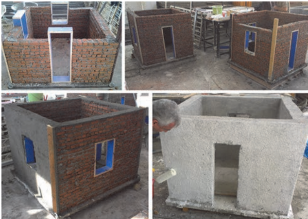
Slika 3. Uzorci zidane konstrukcije
