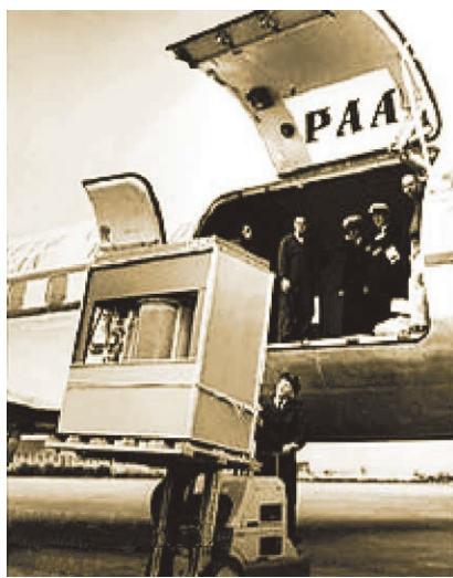
Prikaz transporta 5 MB IBM hard diska 305 RAMAC HDD (primjer iz 1956.)
