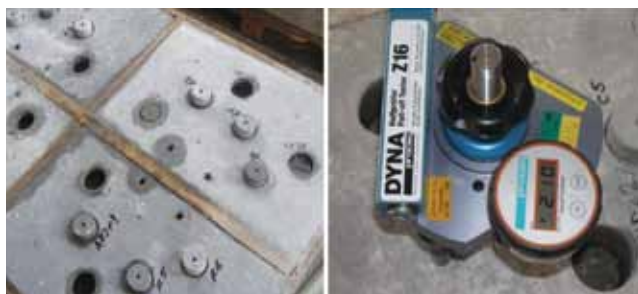
Slika 9. Provođenje ispitivanja prionljivosti reprofilijskog sustava na betonskoj podlozi otkidanjem ( Pull off test )
