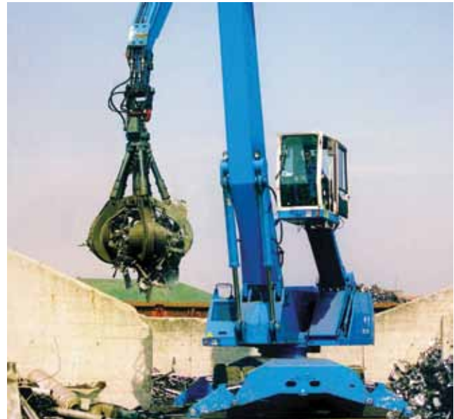
Slika 3. Prikaz rada grabfera (grabilice) pri pretovaru otpada [7]
