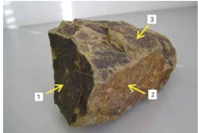
Slika 12. Uzorak s tri međusobno gotovo okomita pukotinska sustava (1. i 3. - sekundarne pukotine; 2. - međuslojna pukotina)
