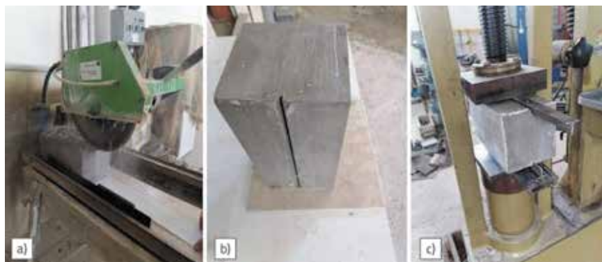
Slika 4. a) Oblikovanje žlijeba na sredini uzorka; b) oblikovani žlijeb dubine 1 cm; c) oblikovanje diskontinuiteta
