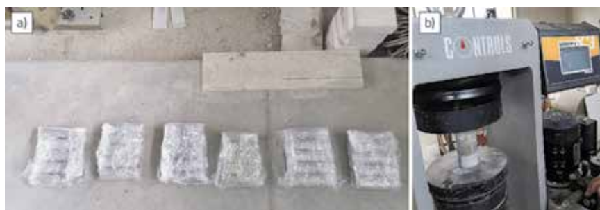
Slika 3. Ispitivanje jednoosne čvrstoće uzoraka
