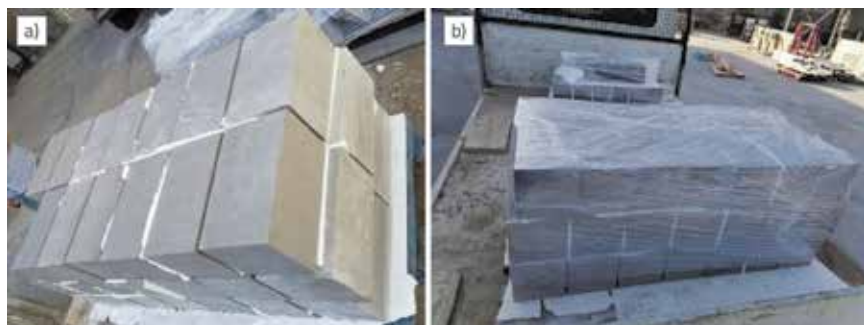
Slika 2. Uzorci obrađeni do željenih dimenzija 30 x 15 x 15 cm
