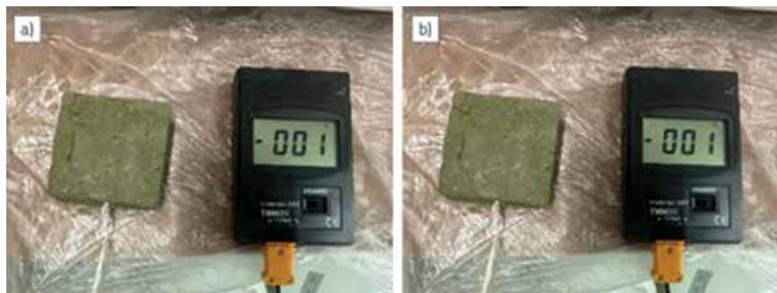
Slika 9. Mjerenje temperature uzoraka tla: a) prije i b) nakon izravnog posmičnog pokusa
