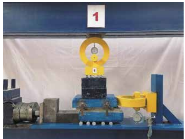
Slika 8. Izgled aparature tijekom trajanja pokusa (vidljivo je smicanje gornje i donje polovine uzorka)
