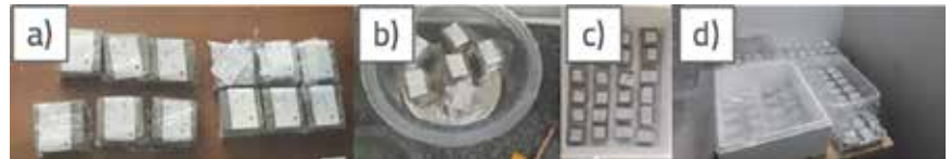
Slika 7. Faze pripreme uzoraka prikazane na fotografijama: a) pripremljeni uzorci; b) postavljanje uzoraka u eksikator; c) slaganje uzoraka u kutije; d) postavljanje uzoraka u komoru za smrzavanje i odmrzavanje
