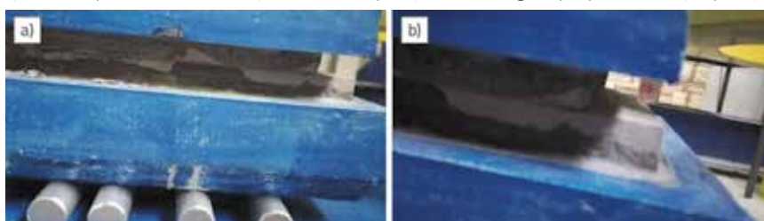
Slika 9. Pomicanje gornje (a) u odnosu na donju (b) polovinu uzorka po posmičnoj plohi
