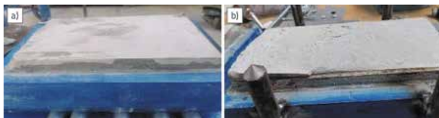
Slika 10. a) Izgled posmične plohe nakon pokusa kod glatkoga uzorka, b) Izgled posmične plohe nakon pokusa kod hrapavoga uzorka
