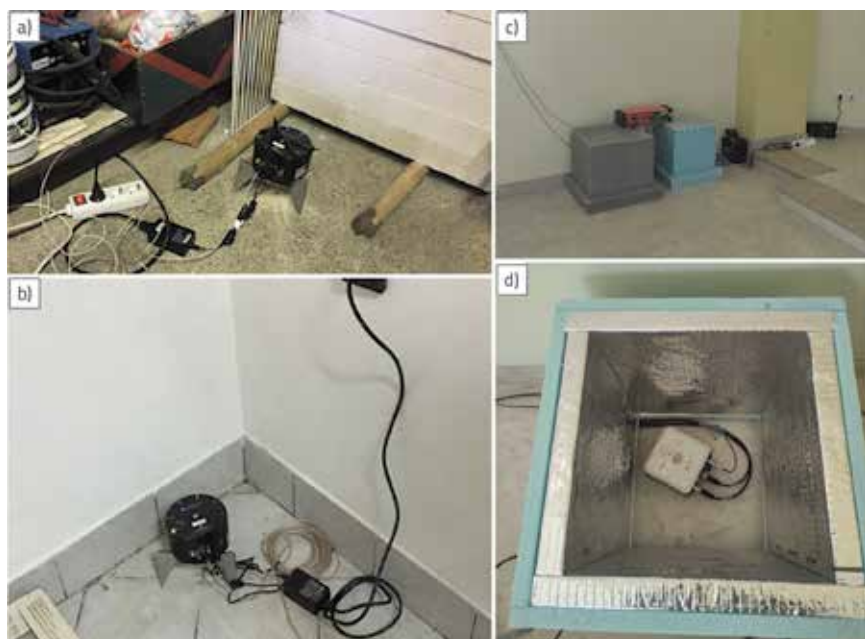
Slika 3. Primjeri instaliranih privremenih postaja: a) Privremene postaje u Sisku i b) Taborištu opremljene kratkoperiodnim instrumentom (seizmograf s integriranim akcelerometrom Lunitek Sentinel-Geo ) iz mreže OP-Net; c) Privremena postaja mreže PN-Net na petrinjskome groblju s kolociranim seizmometrom Kinematics MBB-2 (siva izolacijska kutija) i akcelerometrom Kinematics ETNA2 (ispod zelene izolacijske kutije); d) Akcelerometar u izolacijskoj kutiji prikazan izbliza
