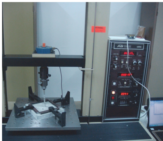
Slika 12. Ispitivanje vlačne čvrstoće ugrađenog sidrišnog elementa
