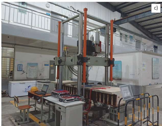
Slika 5. Ispitivanje zamora nosača: a) sustav uzorkovanja naprezanja i deformacije; b) sustav opterećenja na zamor; c) ispitno opterećenje nosača
