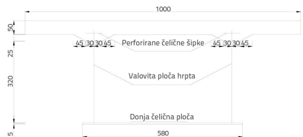
Slika 1. Dimenzije poprečnog presjeka za geometrijski model (mjerna jedinica: mm)
