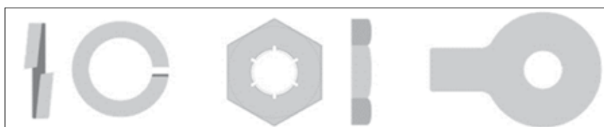
Slika 8. Rasječena prstenasta podloška (lijevo), sigurnosna matica, odnosno PAL matica (sredina), podloška s jezičcem (desno)
