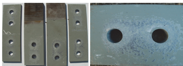
Slika 6. Uzorci zategnuti M16 vijcima nakon ispitivanja
