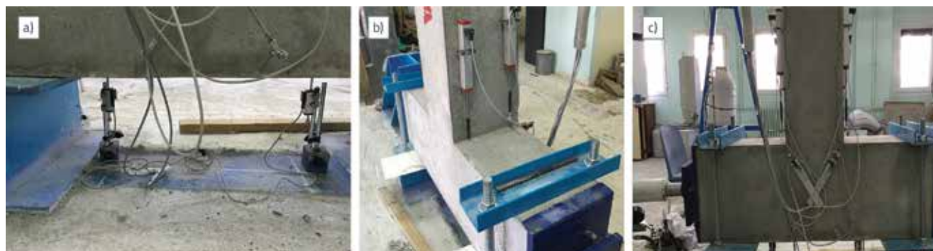
Slika 12. Primjena LVDT senzora: a) Rotacije stupa; b) Rotacije grede; c) Distorzija spoja
