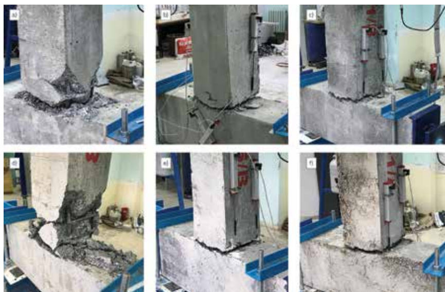
Slika 5. Oblici sloma betonskih uzoraka: a) Uzorak NC0; b) Uzorak NC0.5; c) Uzorak NC1; d) Uzorak SCC0; e) Uzorak SCC0.5; f) Uzorak SCC1
