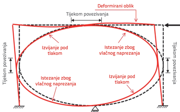
Slika 1. Nelinearna deformacija u eliptičnom vezu [15-21]
