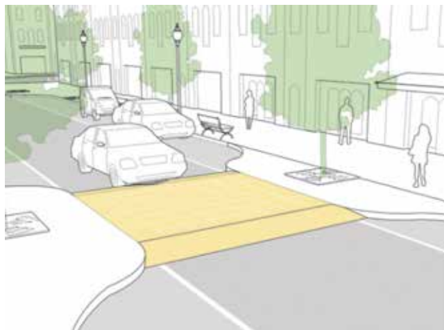
Slika 3. Uzdignuta platforma u funkciji pločnika [5]
