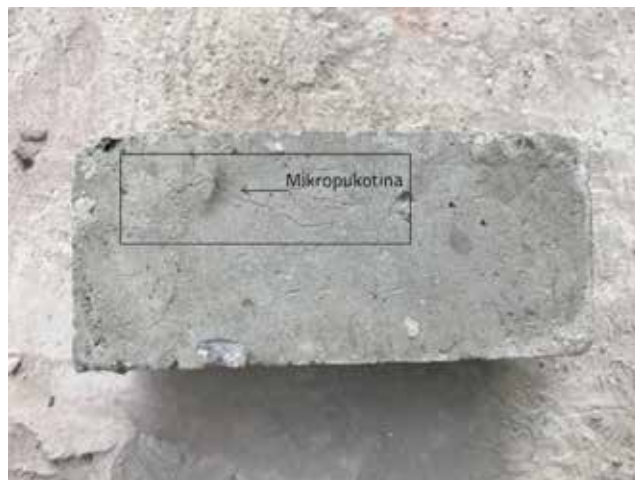
Slika 5. Pukotine na uzorku koji je sušen sat vremena na temperaturi od 600 °C
