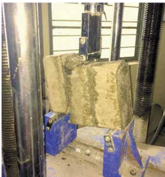
Slika 9. Ispitivanje posmične čvrstoće uzorka
