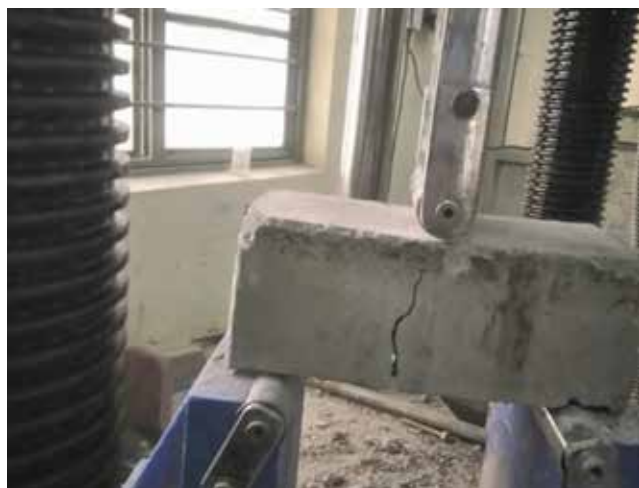
Slika 7. Ispitivanje čvrstoće na savijanje uzorka
