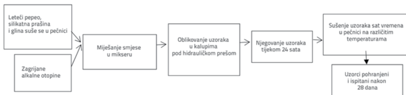
Slika 1. Proces izrade geopolimerne opeke
