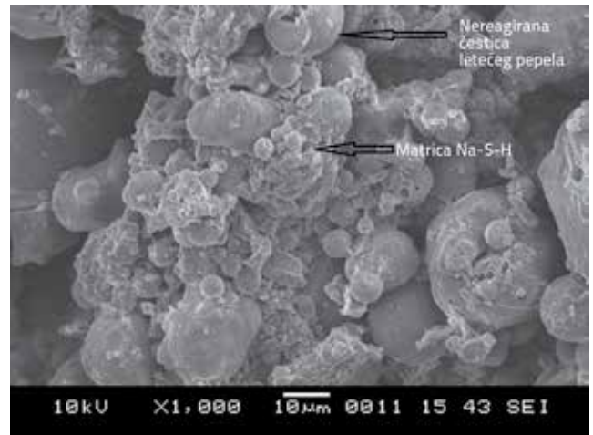
Slika 13. Mikroskopska snimka geopolimerne opeke
