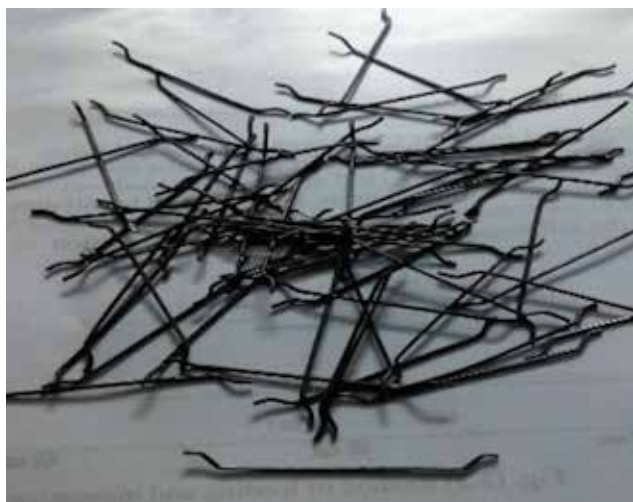
Slika 2. Čelična vlakna s kukama na kraju
