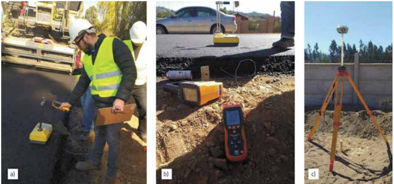
Slika 4. Prikupljanje podataka o temperaturi i gustoći (lijevo i u sredini) te prikupljanje geodetskih podataka (desno)
