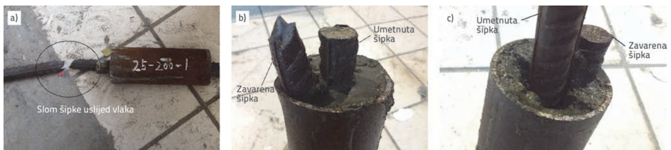
Slika 8. Slom šipke uslijed vlaka: a) slom šipke uslijed vlaka; b) oštećenje injekcijske smjese na dnu prstena blizu fiksnog kraja; c) oštećenje injekcijske smjese na dnu prstena blizu opterećenog kraja
