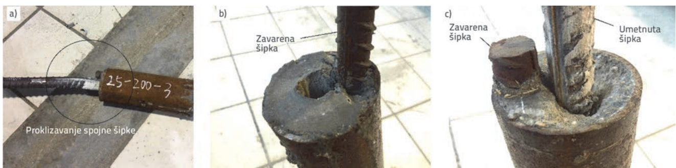
Slika 9. Slom spoja šipke i injekcijske smjese: a) proklizavanje spojne šipke; b) oštećenje injekcijske smjese na dnu prstena blizu fiksnog kraja; c) oštećenje injekcijske smjese na kraju prstena blizu opterećenog kraja
