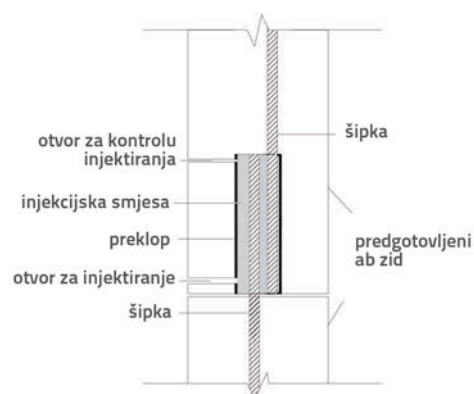
Slika 3. Skica injektirane prstenaste preklopne veze
