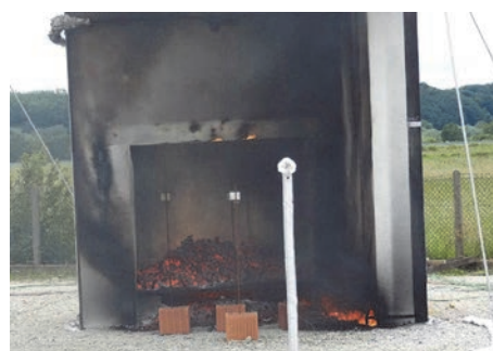
Slika 14. 54 minute nakon početka – tinjanje uzorka EM_2
