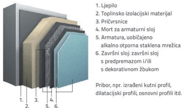
Slika 1. Komponente ETICS sustava [3, 4]
