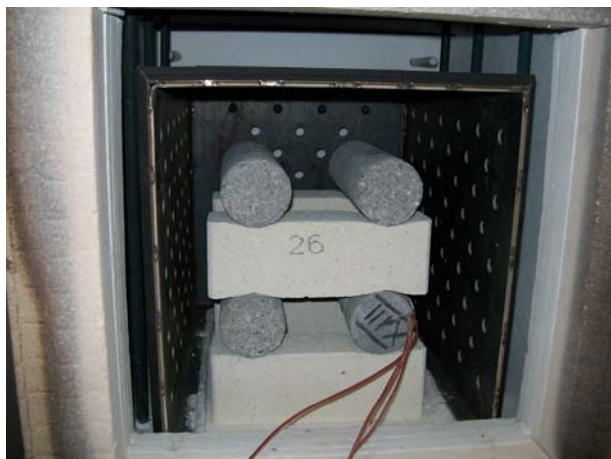
Slika 1. Prikaz betonskih uzoraka u električnoj peći
