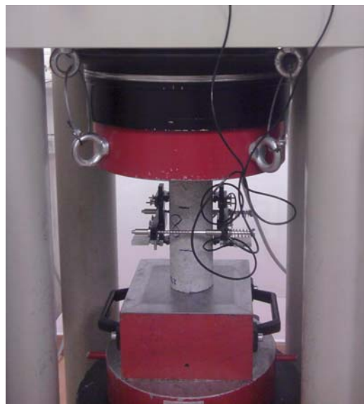
Slika 9. Uzorak s postavljenim ekstenziometrima za mjerenje relativnog pomaka
