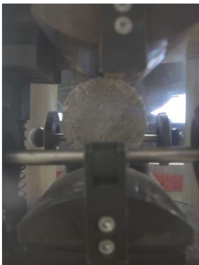
Slika 7. Prikaz uzorka s uloškom za cijepanje
