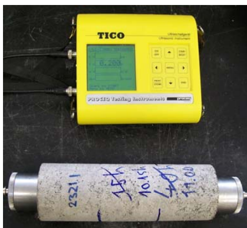
Slika 10. Uzorak s uređajem za mjerenje dinamičkog modula elastičnosti
