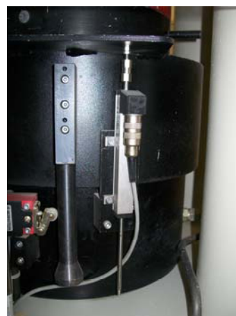
Slika 6. LVDT uređaj na preši za mjerenje pomaka čelične ploče preše
