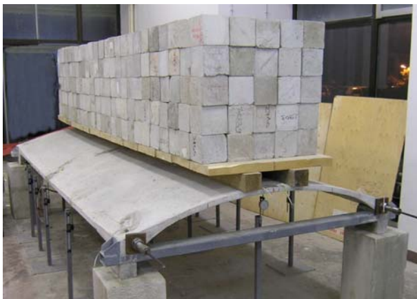
Slika 2. Izgled ljuske s ukupnim stalnim opterećenjem
